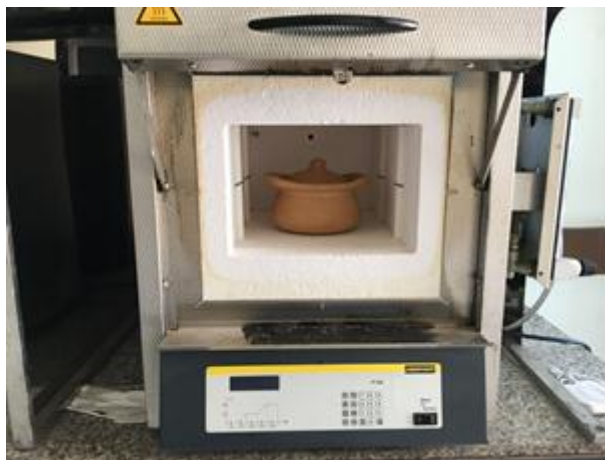
รูปที่ 3.5 การใส่หม้อดินเผาที่บรรจุแท่งเชื้อเพลิงแล้วในเตาเผา
