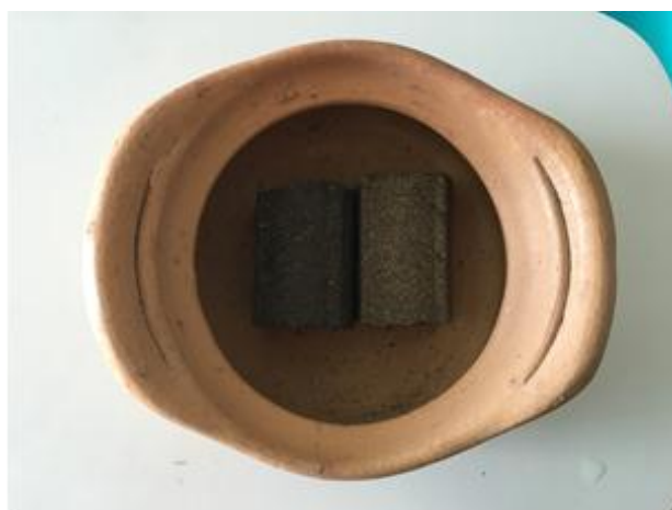
รูปที่ 3.4 การเรียงแท่งเชื้อเพลิงในหม้อดินเผา
