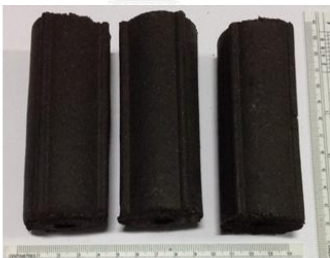
รูปที่ 3.3 ลักษณะของแท่งเชื้อเพลิงจากกากตะกอนน้ำเสียชุมชนที่ขึ้นรูปด้วยเทคนิคเอ็กซ์ทรูชัน
