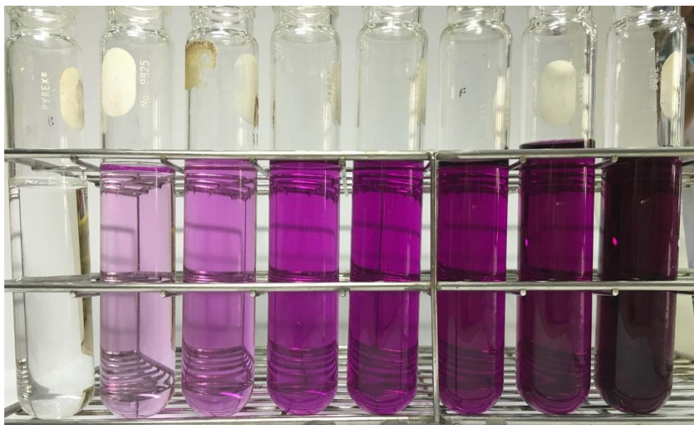
รูปที่ 4.4 ลักษณะสีของน้ำเสียสังเคราะห์ที่มีสีรีแอกทีฟไวโอเล็ต 5 ความเข้มข้นต่างๆในหน่วย เอดีเอ็มไอ ก่อนเข้าระบบถังกรองไร้อากาศ
