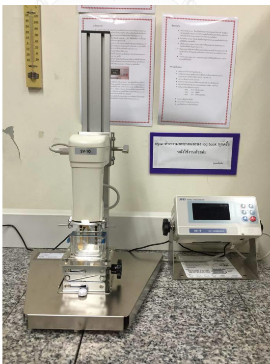
รูปที่ 3.3 เครื่องวัดความหนืด รุ่น SV-10
