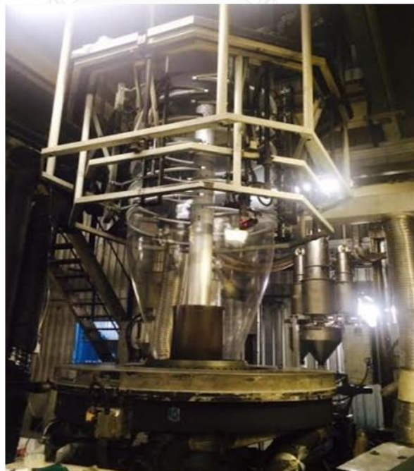
รูปที่ 3.2 เครื่องอัดรีดเป่าฟิล์มแบบ 3 สกรู
