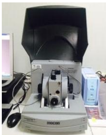
รูปที่ 3.6 เครื่องทดสอบการซึมผ่านของไอน้ำ
