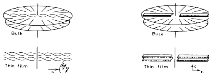
รูปที่ 2.13 สันฐานวิทยาของ LDPE ที่ได้จากการทดลองของ Keller a) Keller I model และ b) Keller II model [9]
