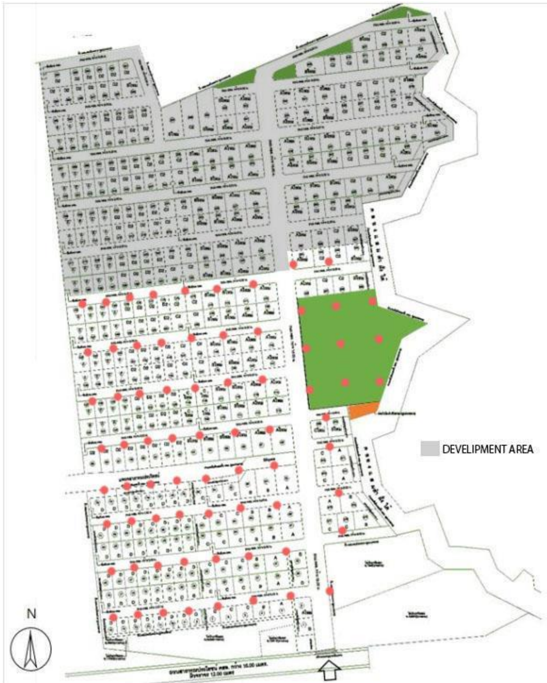
ภาพที่ 4- 2 ตำแหน่งเสาไฟถนนโซล่าเซลล์ในโครงการไอส์ฟาร์ค
