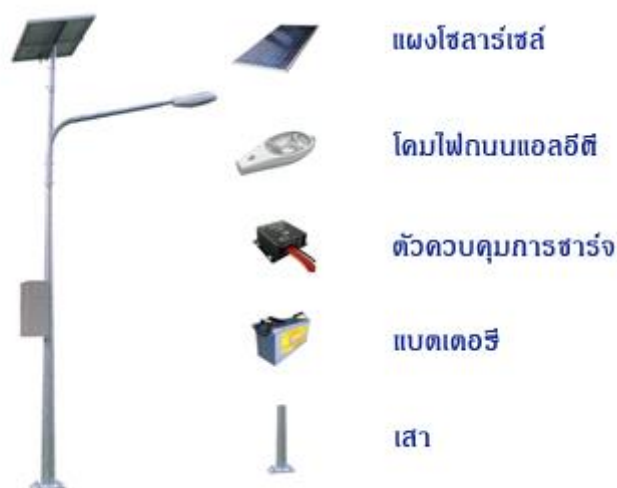
ภาพที่ 3- 21 ส่วนประกอบของเสาไฟถนนโซลาร์เซลล์
