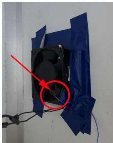
ภาพที่ 3.7: จุดวัดอุณหภูมิช่องอากาศออก
