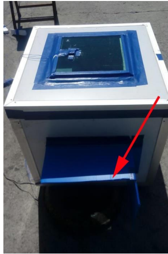
ภาพที่ 3.5: การบังหัววัดอุณหภูมิจากแสงแดด
