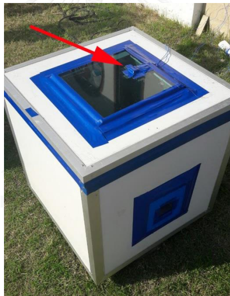
ภาพที่ 3.4: จุดวัดอุณหภูมิของผิวกระจกด้านนอก
