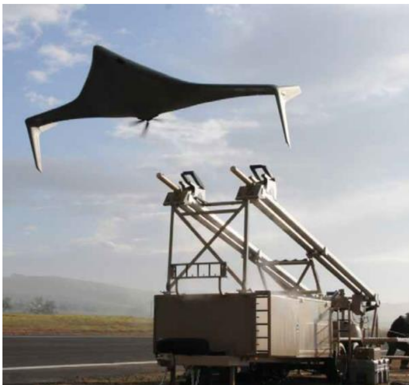
ภาพที่ 4.23 อากาศยานไร้คนขับแบบ BAT-12 ที่มา : กองทัพอากาศ กรมยุทธศึกษาทหารเรือ (2558)
