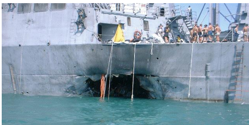
ภาพที่ 4.13 ความเสียหายของ USS.Cole DDG-67 จากการถูกก่อการร้าย ที่มา : Countryman & McDaniel (2543)
