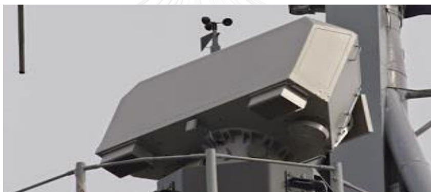
ภาพที่ 4.24 เสาอากาศของเรดาร์ SEA GIRAFFE AMB
