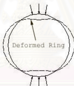
รูปที่ 2.5 การเสียรูปของดาดคูโมงค์ในลักษณะ Unconfined ring ภายใต้หน่วยแรงกระทำไม่คงที่ (concentrated load)
