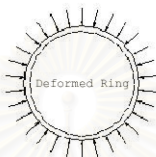
รูปที่ 2.4 การเสียรูปของดาดคูโมงค์ในลักษณะ Unconfined ring ภายใต้หน่วยแรงกระทำคงที่ (uniform load)
