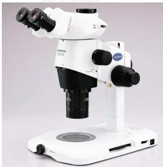
รูปภาพที่ 5 แสดงภาพกล้อง Stereomicroscope (Olympus SZX 16)
