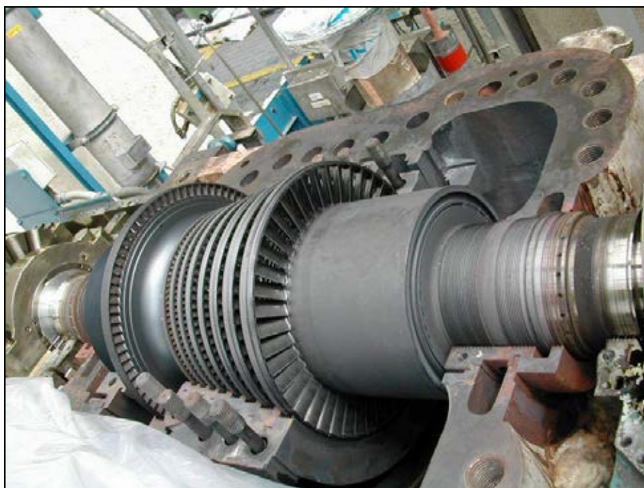
รูปที่ ๑.๘ ใบพัดกังหันไอน้ำ X4401 (Ethylene compressor turbine)
