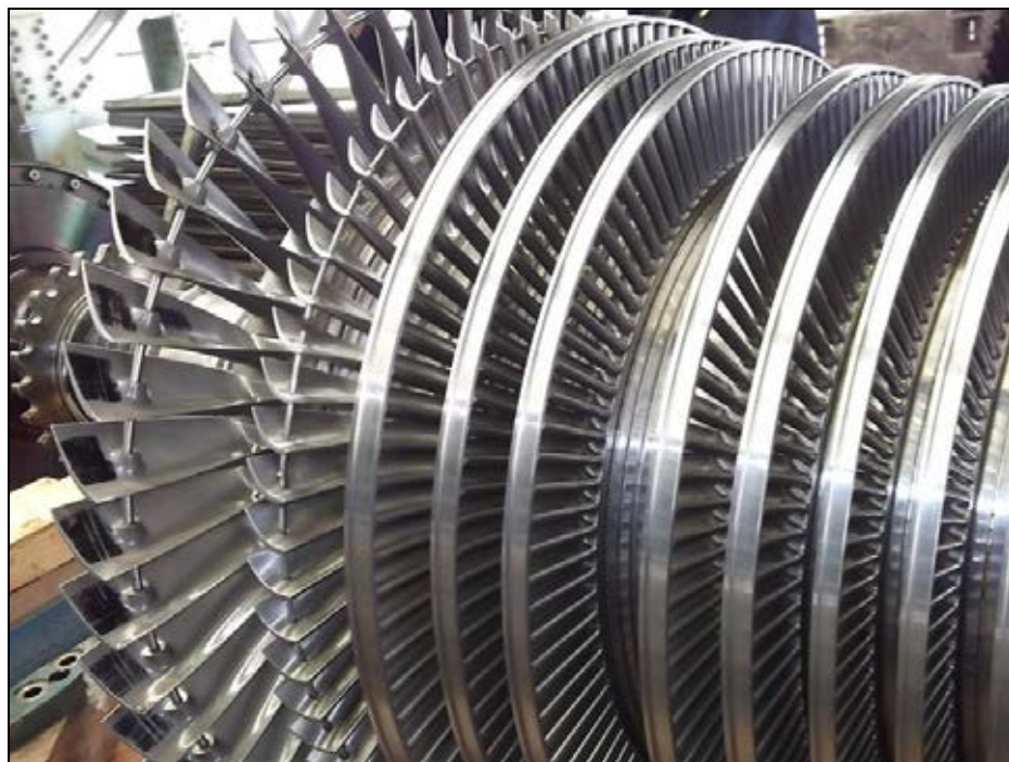
รูปที่ ๑.๗ ใบพัดกังหันไอน้ำ X3201 (Cracked gas compressor turbine)
