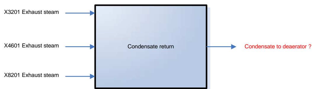
รูปที่ 5.26 สมดุลมวลน้ำคอนเดนเสท กรณีศึกษาที่ 4
