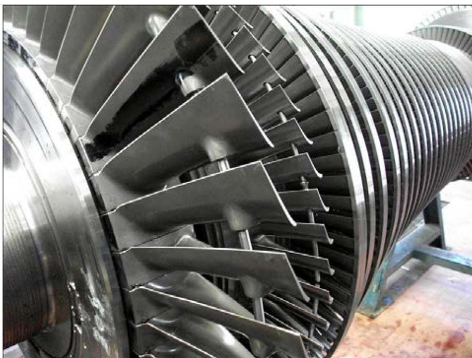
รูปที่ ๑.6 ใบพัดกังหันไอน้ำ X3201 (Cracked gas compressor turbine)
