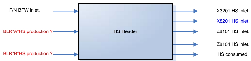
รูปที่ 5.41 สมดุลมวลระดับความดัน HS กรณีศึกษาที่ 6 (ขั้นตอนลด LLS Admission)
