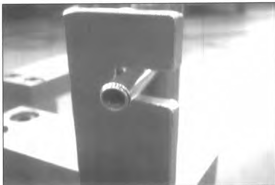
รูปที่ 4.8 แสดงอุปกรณ์จับยึดตัวที่ 1 หลังการปรับปรุงโดยติดตั้ง pin ลงไป
