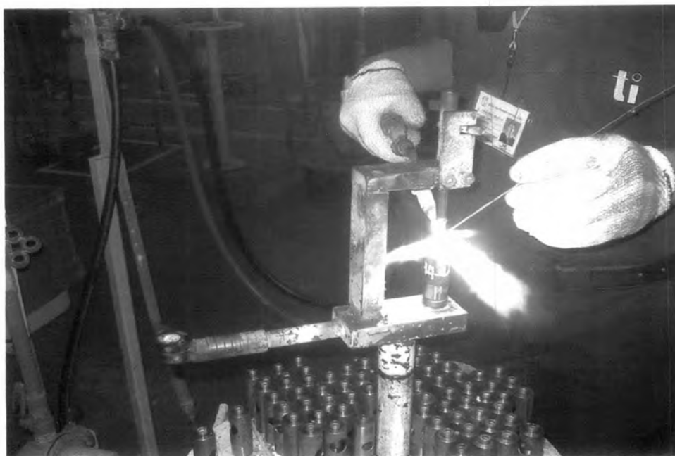
รูปที่ 4.7 แสดงอุปกรณ์จับยึดตัวที่ 1 หลังการปรับปรุง
