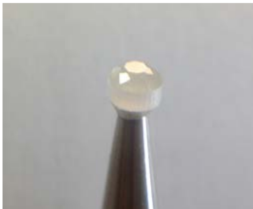
รูปที่ 5.10 เม็ดพลอยที่ผ่านการเจียรไนด้านบนของเม็ดพลอย
