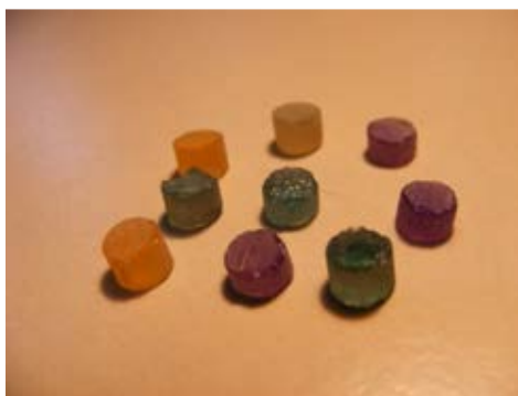
รูปที่ 5.1 พลอยที่ผ่านการแต่งเกลารูปทรงเบื้องต้นแล้ว
