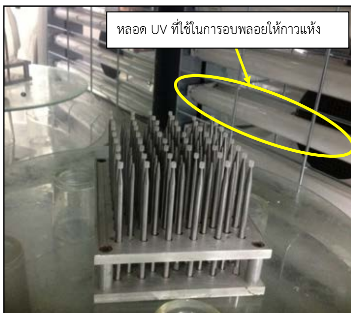
รูปที่ 5.3 การอบชุดพลอยที่ติดกาวแล้วในตู้อบยูวี
