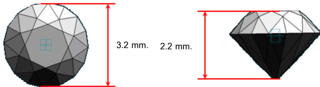
รูปที่ 6.19 เหลี่ยมพลอยและขนาดที่ได้จากการออกแบบด้วยโปรแกรม CU-Solid
