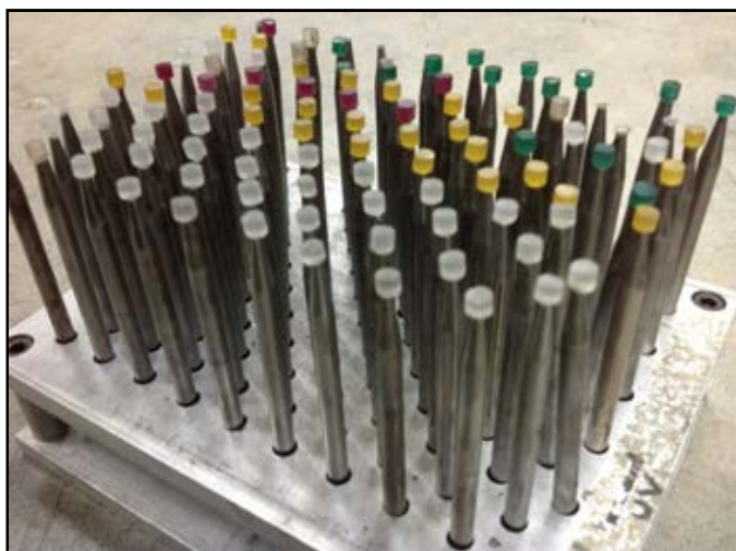
รูปที่ 5.2 การติดพลอยเข้ากับทวนติดพลอยด้วยกาวยูวี
