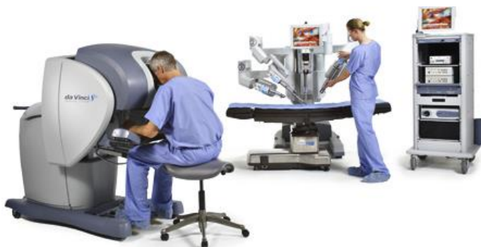
ภาพที่ 2.2 หุ่นยนต์แขนกลสำหรับงานผ่าตัด The DaVinci ® Surgical System [1]
