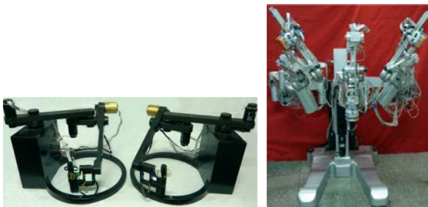
ภาพที่ 2.4 หุ่นยนต์แขนกลนำ-แขนกลตาม MicroHand A [5]
