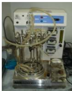
ถังปฏิกรณ์ ( Marubishi Model MDL, Japan)
