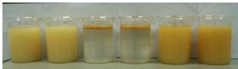
ภาพที่ ข-1.5 ผลของความเข้มข้นเฟอริกคลอไรด์ ในการบำบัดด้วยวิธีจาร์เทสต์
