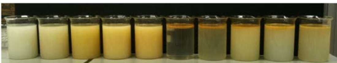
ภาพที่ ข-1.4 ผลของความเป็นกรด-ด่าง ของเฟอริกคลอไรด์ ในการบำบัดด้วยวิธีจาร์เทสต์
