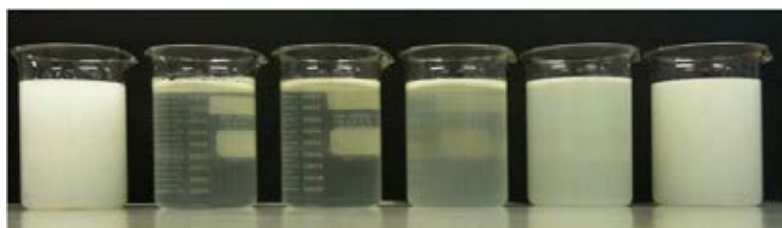
ภาพที่ ข-1.3 ผลของความเข้มข้นสารส้ม ในการบำบัดน้ำเสียด้วยวิธีจาร์เทสต์
