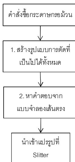
ภาพที่ 5.2 ขั้นตอนในการหาคำตอบสำหรับปัญหาเศษตัดริมกระดาษของเครื่องจักรแปรรูป Slitter
