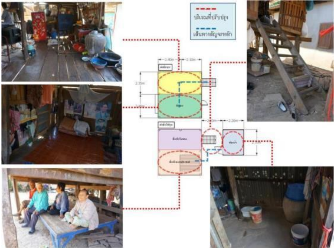
ภาพที่ 6.19 แสดงผังการอยู่อาศัยและจุดที่ต้องปรับปรุงของแม่กี ตำบลบ้าน
