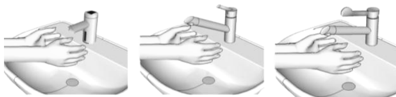
ภาพที่ 2.12 แสดงลักษณะมือจับก๊อกน้ำที่อ่างล้างมือ ที่เป็นก้านยื่น หรือแบบมีเซ็นเซอร์อัตโนมัติ
