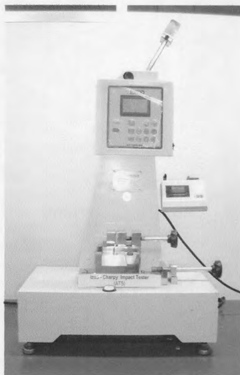
รูปที่ 3.14 เครื่องทดสอบความต้านแรงกระแทก รุ่น GOTECH GT-7045-MD
