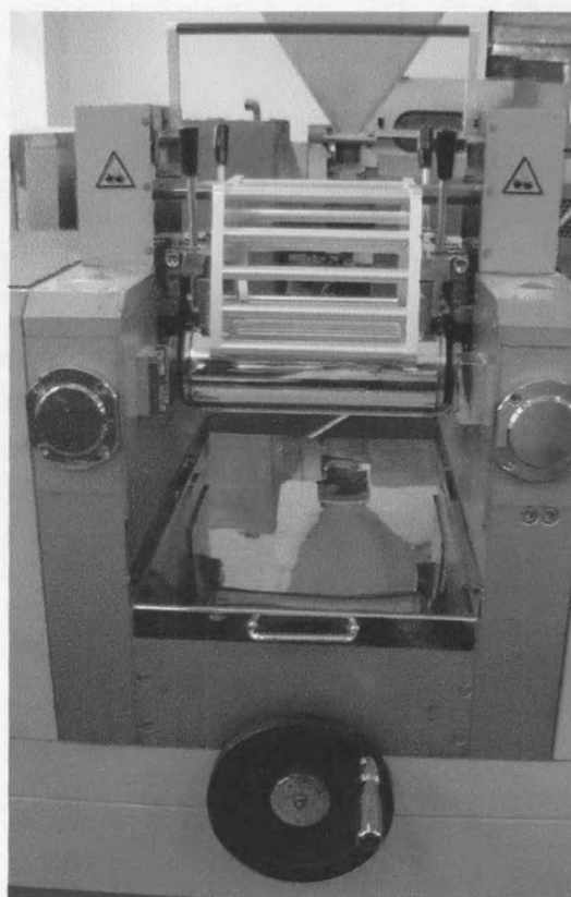
รูปที่ 3.4 เครื่องบดผสมแบบสองลูกกลิ้ง (two-roll mill) รุ่น LAB TECH
