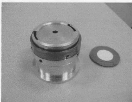
รูปที่ 3.2 ส่วนประกอบและลักษณะของแผ่นที่ยึดตัวอย่าง (sample holder)
