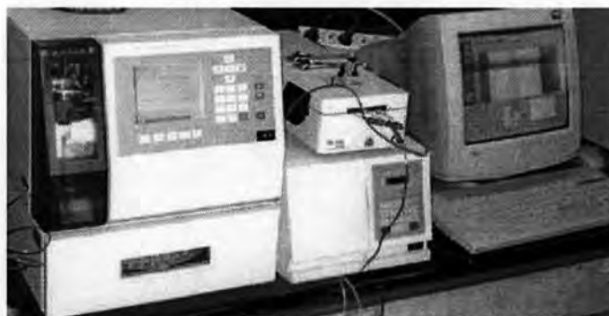
รูปที่ 3.6 เครื่องเจลเพอมีเอชันโครมาโตกราฟี รุ่น Waters 600 controller
