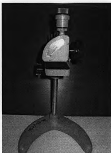
รูปที่ 3.8 เครื่องดูโรมิเตอร์ (Durometer) ชนิด Shore D
