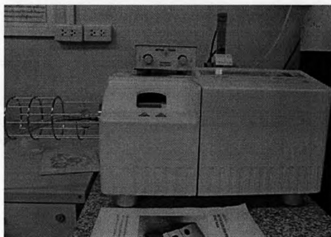
รูปที่ 3.14 เครื่อง TGA ยี่ห้อ Mettler Toledo รุ่น TGA/SDTA 851 o
