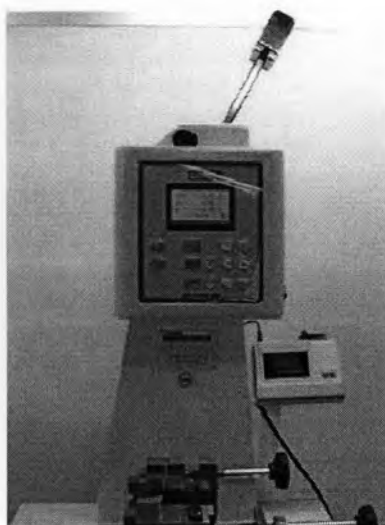
รูปที่ 3.9 เครื่องทดสอบความทนแรงกระแทก รุ่น GT-7045-MDH
