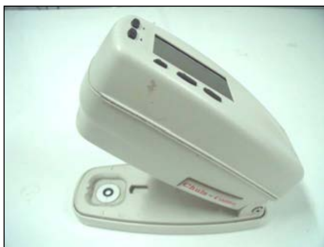
ภาพที่ 3-3 เครื่องสเปกโตรเดนซิโตมิเตอร์ (Spectrodensitometer)
