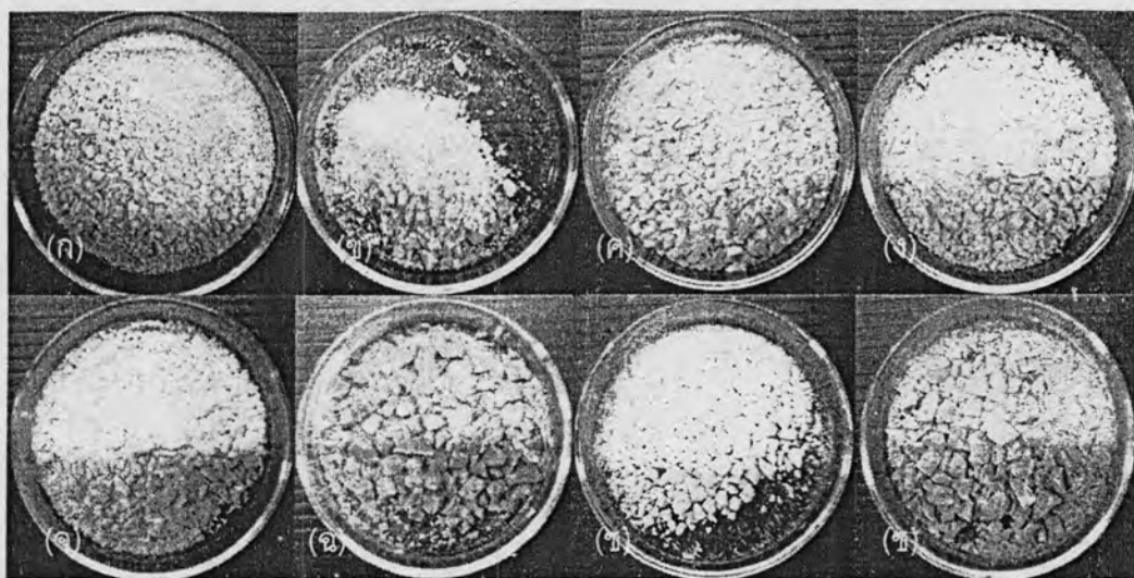
รูปที่ 4.11 พอลิเอทิลีนเทเรฟทาเลตที่สังเคราะห์ได้จากผลผลิตไกลโคไลซ์สูตรที่ 1 (ก) 2 (ข) 3 (ค) 4 (ง) 5 (จ) 6 (ฉ) 7 (ช) และ 8 (ช)
