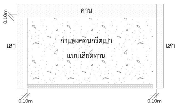
รูปที่ 3.2 รายละเอียดของกำแพงคอนกรีตเบาแบบเสียดทาน
