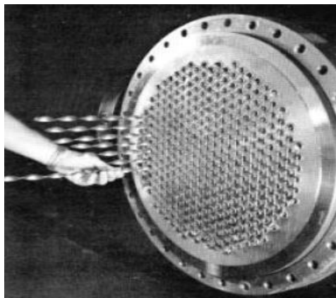
รูปที่ 1.3 การติดตั้งเทอร์บิวเลเตอร์ภายในเครื่องแลกเปลี่ยนความร้อนแบบเปลือกและท่อ [2]
