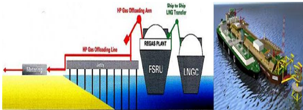
รูปที่ 1-5 คลังกักเก็บลอยน้ำและหน่วยแปลงสถานะ [14]
