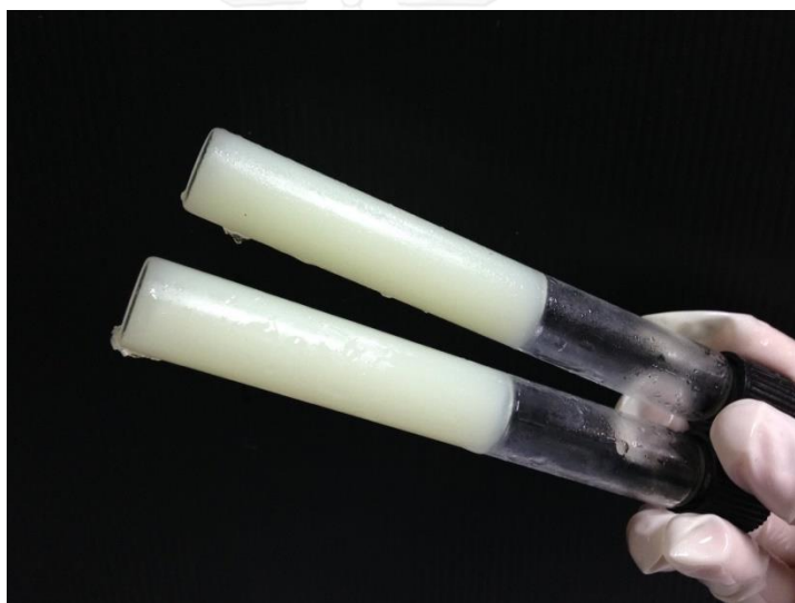
ภาพ ค-2 ตัวอย่างของเชื้อเพลิงชีวภาพที่ไม่สามารถไหลเทได้
