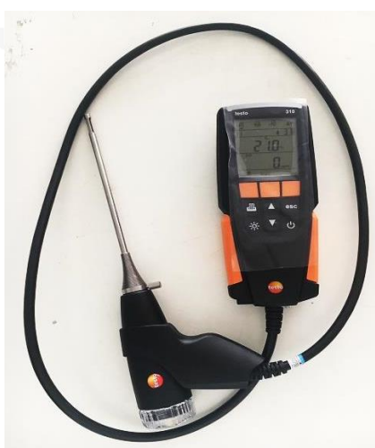
ภาพที่ 4-18 เครื่องวัดปริมาณไอเสีย (gas analyzer testo 310)
