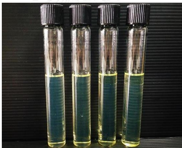
ภาพที่ 4-2 ตัวอย่างของเชื้อเพลิงชีวภาพที่มีลักษณะใสรวมตัวเป็นเนื้อเดียวกันเปรียบเทียบกับเชื้อเพลิงชีวภาพที่มีลักษณะขุ่นและเมื่อตั้งทิ้งไว้เชื้อเพลิงชีวภาพเกิดการแยกชั้น
