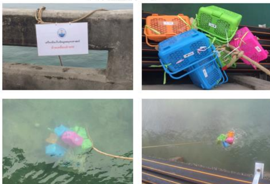
รูปที่ 4.15 การติดตั้งตัวดักจับในน้ำทะเล
