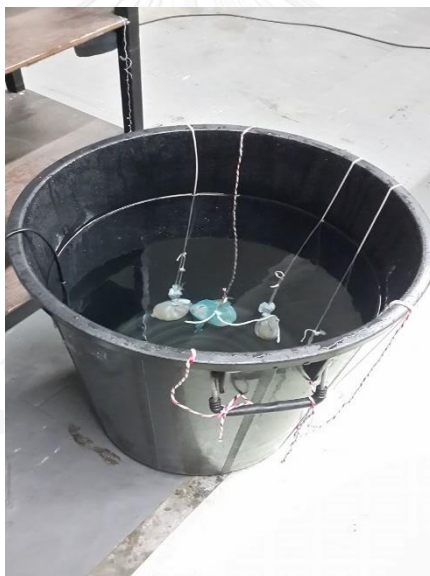
รูปที่ 3.4 ตัวดูดซับในถังน้ำที่มีปริมาตรน้ำ 60/80 ลิตร ในห้องปฏิบัติการทดลอง
