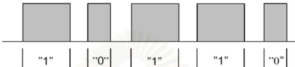
รูปที่ 2-21 การเข้ารหัสโดยใช้ความกว้างของพัลส์
