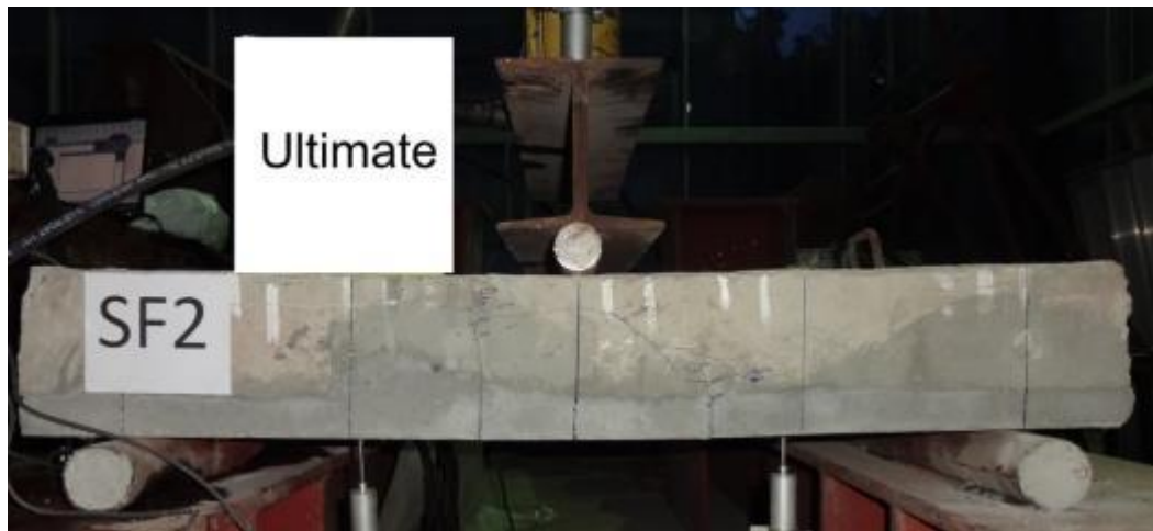
ภาพที่4-35 ลักษณะการวิบัติของพื้นตัวอย่างSF2
