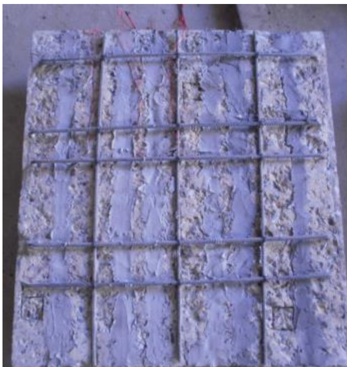
ภาพที่3-14 ลักษณะการติดตั้งแท่งพอลิเมอร์แบบสลับนพื้นปลา
