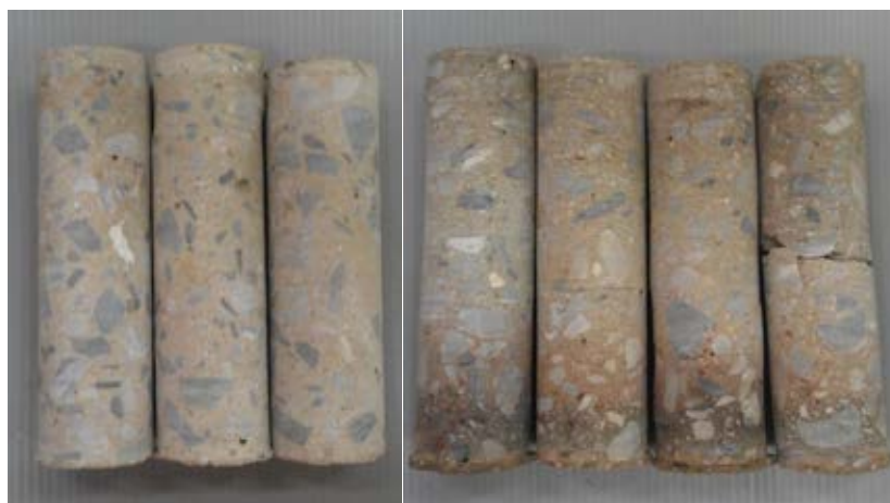
ภาพที่4-25 ผลการเจาะทดสอบคอนกรีตกำลังอัด240ksc
