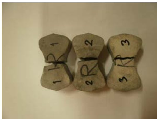
ภาพที่4-27 ลักษณะการวิบัติของตัวอย่างทดสอบกำลังรับแรงดึง
