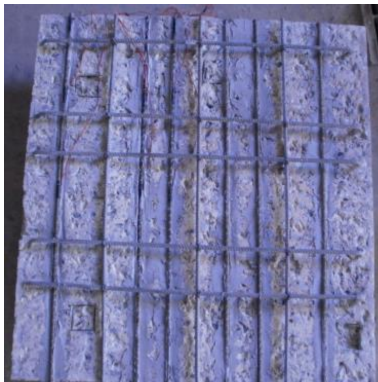
ภาพที่3-16 ลักษณะการติดตั้งแท่งพอลิเมอร์แบบวางระหว่างชั้นผิวแกร่งกับชั้นซอมแซม
