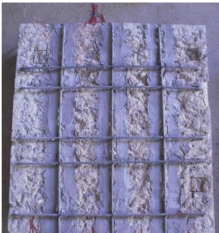
ภาพที่3-13 ลักษณะการติดตั้งแท่งพอลิเมอร์แบบตรงกับเหล็กเสริม
