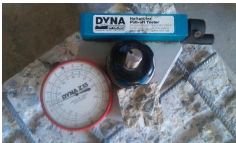
ภาพที่ 3-10 เครื่องดึงทดสอบและลักษณะการวิบัติของชิ้นตัวอย่าง
