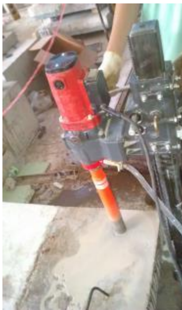
ภาพที่ 3-19 การเจาะทดสอบตัวอย่างคอนกรีต
