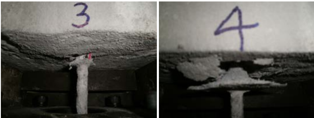
ภาพที่4-4 ลักษณะการวิบัติของตัวอย่างทดสอบกำลังรับแรงยึดเหนี่ยว (ซ้าย) ระหว่างชั้นผิวแกร่งกับวัสดุซ่อมตัวที่1,(ขวา) ระหว่างชั้นผิวแกร่งกับวัสดุซ่อมตัวที่2
