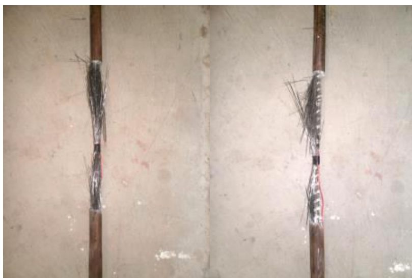
ภาพที่ 4-1 ลักษณะการวิบัติของแท่งพอลิเมอร์เสริมเส้นใย
