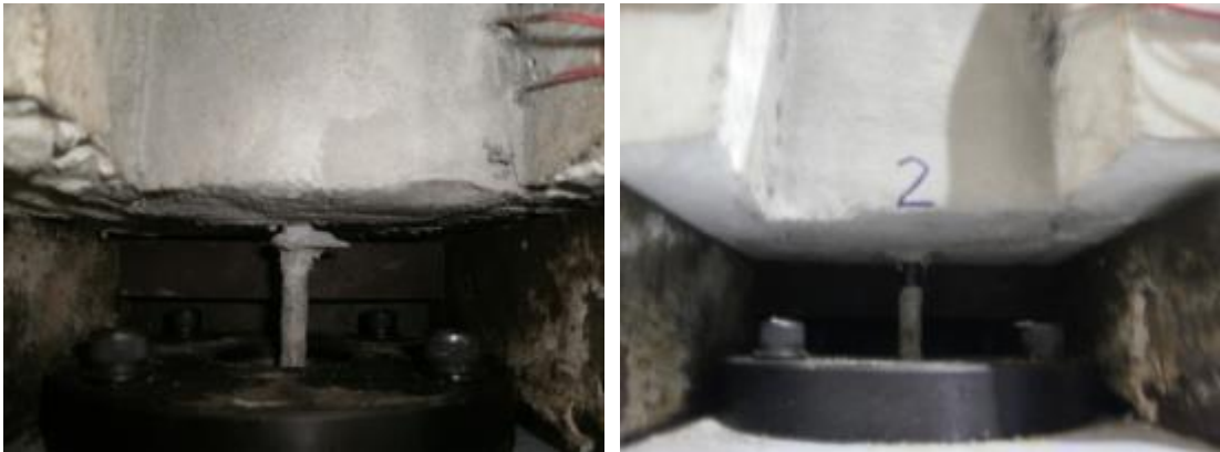
ภาพที่4-3 ลักษณะการวิบัติของตัวอย่างทดสอบกำลังรับแรงยึดเหนี่ยว (ซ้าย) ชั้นผิวแกร่งตัวที่1, (ขวา) ชั้นผิวแกร่งตัวที่2
