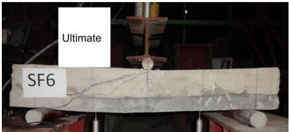
ภาพที่4-43 ลักษณะการวิบัติของพื้นตัวอย่างSF6
