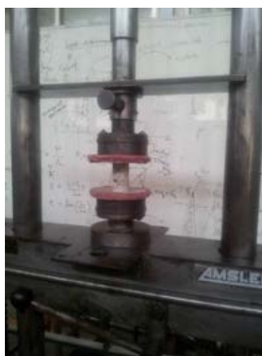
ภาพที่ 3-20 การทดสอบกำลังอัดของคอนกรีต
