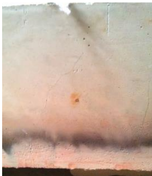
ภาพที่4-24 สีและรอยร้าวหลังจากเก็บชิ้นตัวอย่างลงมา
