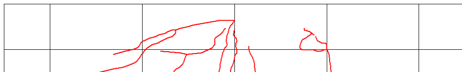
ภาพที่4-40 รอยร้าวในแต่ละน้ำหนักกระทำของของพื้นตัวอย่างSF4
