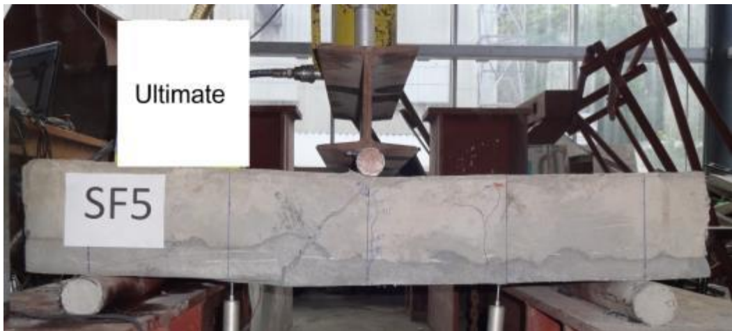
ภาพที่4-41 ลักษณะการวิบัติของพื้นตัวอย่างSF5
