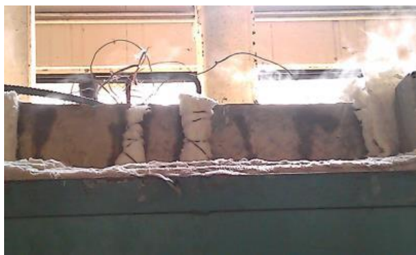
ภาพที่4-23 น้ำในคอนกรีตที่ซึมออกมาขณะเผาไฟ
