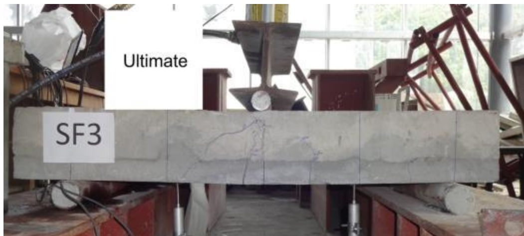
ภาพที่4-37 ลักษณะการวิบัติของพื้นตัวอย่างSF3
