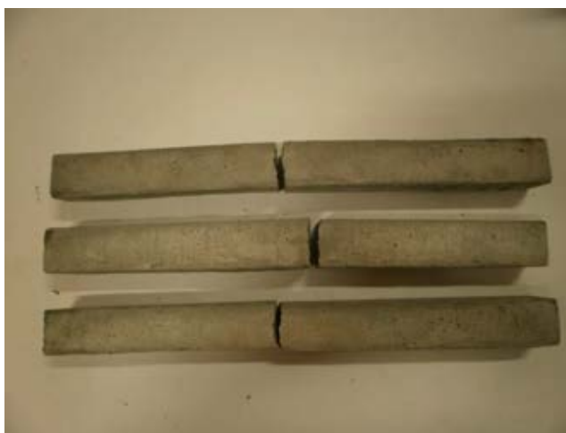
ภาพที่4-28 ลักษณะการวิบัติของตัวอย่างทดสอบกำลังรับแรงดัด
