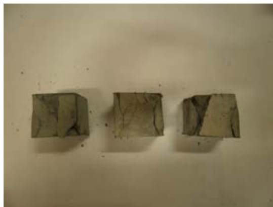
ภาพที่4-26 ลักษณะการวิบัติของตัวอย่างทดสอบกำลังรับแรงอัด
