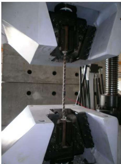
ภาพที่3-2 การทดสอบรับแรงดึงของแท่งพอลิเมอร์เสริมเส้นใยคาร์บอน
