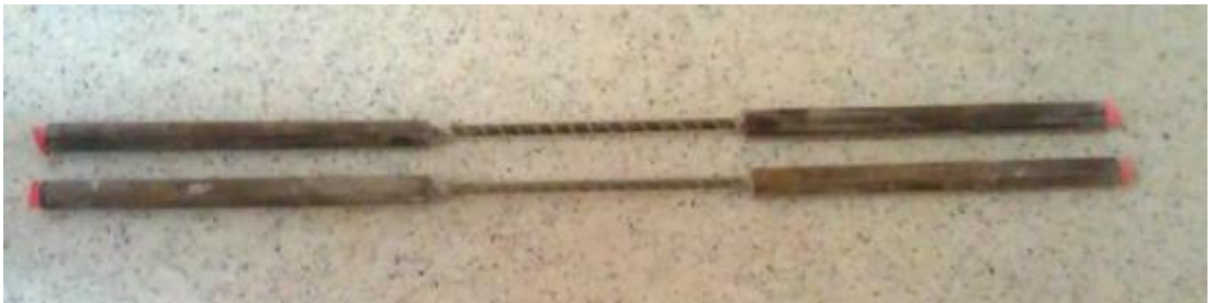
ภาพที่ 3-1 แท่งพอลิเมอร์เสริมเส้นใยที่เตรียมไว้ทดสอบรับแรงดึง
