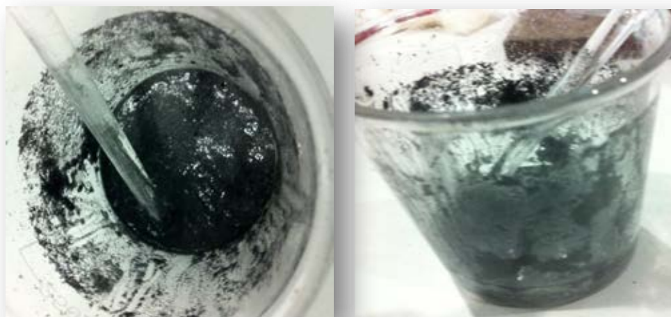
รูปที่ 4.2 แสดงการเกิดก๊าซขณะสังเคราะห์ตัวกลางร่วมเหล็ก/อะลูมิเนียมภายใต้สภาวะ 1 M \text{FeCl}_2 \cdot 4\text{H}_2\text{O} , 1.6 M NaCl และ 0.4 M HCl
