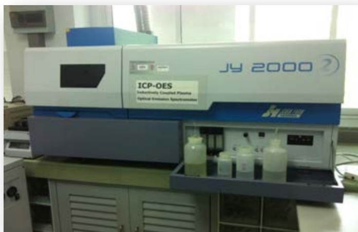
รูปที่ 3.1 เครื่อง Inductively Coupled Plasma optical emission spectrometer (ICP-OES)
