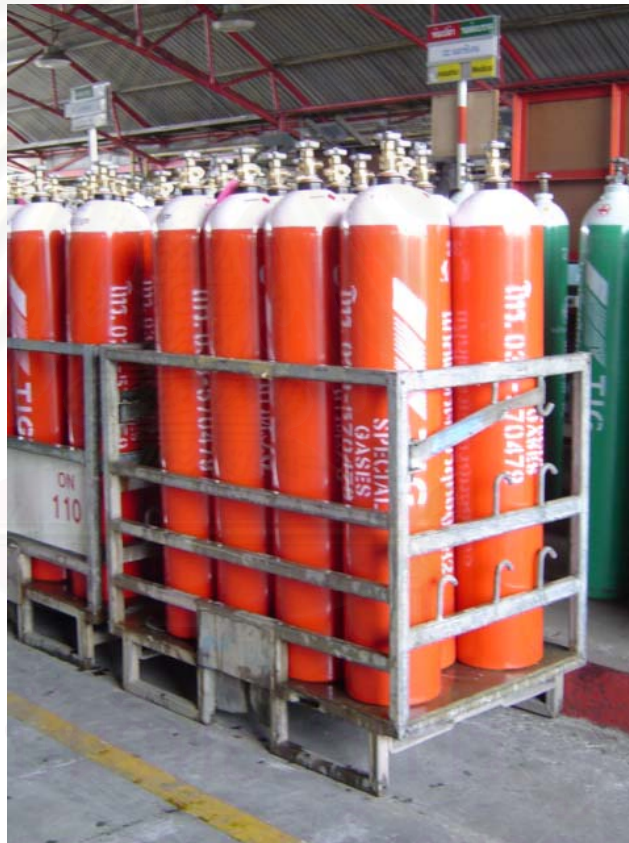
รูปที่ 5-4 พาเลท (Pallet) ที่ใช้ในการขนย้ายท่อระหว่างการผลิต
