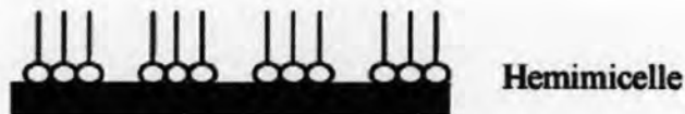
รูปที่ 2.14 สารลดแรงตึงผิวที่เกาะบนเส้นใยในรูปเฮมิไมเซลล์ Alila et al., 2005)
