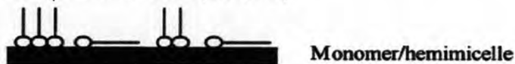
รูปที่ 2.13 สารลดแรงตึงผิวที่เกาะบนเส้นใยในรูปโมโนเมอร์และเฮมิไมเซลล์ Alila et al., 2005)
