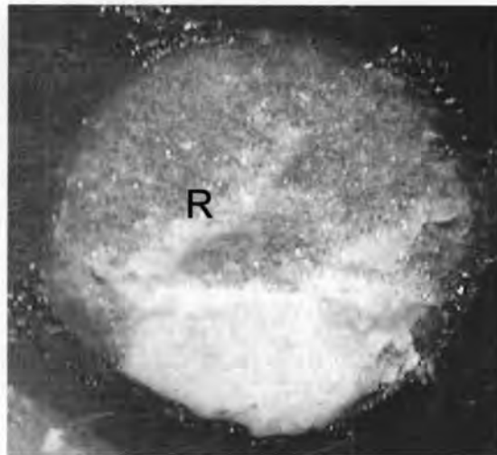
รูปที่ 10 ภาพถ่ายจากกล้องจุลทรรศน์ชนิดสเตอริโอแสดงการแตกหัก ภายหลังจากการทดสอบความแข็งแรงดิ่งยึดบริเวณรอยต่อผิวเรซินคอมโพสิตที่ยึดกับเรซินซีเมนต์Super-Bond พบว่าการแตกหักอยู่ในชั้นเรซินและการแตกระหว่างชั้นเรซินกับแท่งพีเอ็มเอ็มเอ โดยจะพบว่ามีเรซิน(R) คลุมอยู่โดยตลอดทั้งพื้นผิวของเรซินคอมโพสิต
