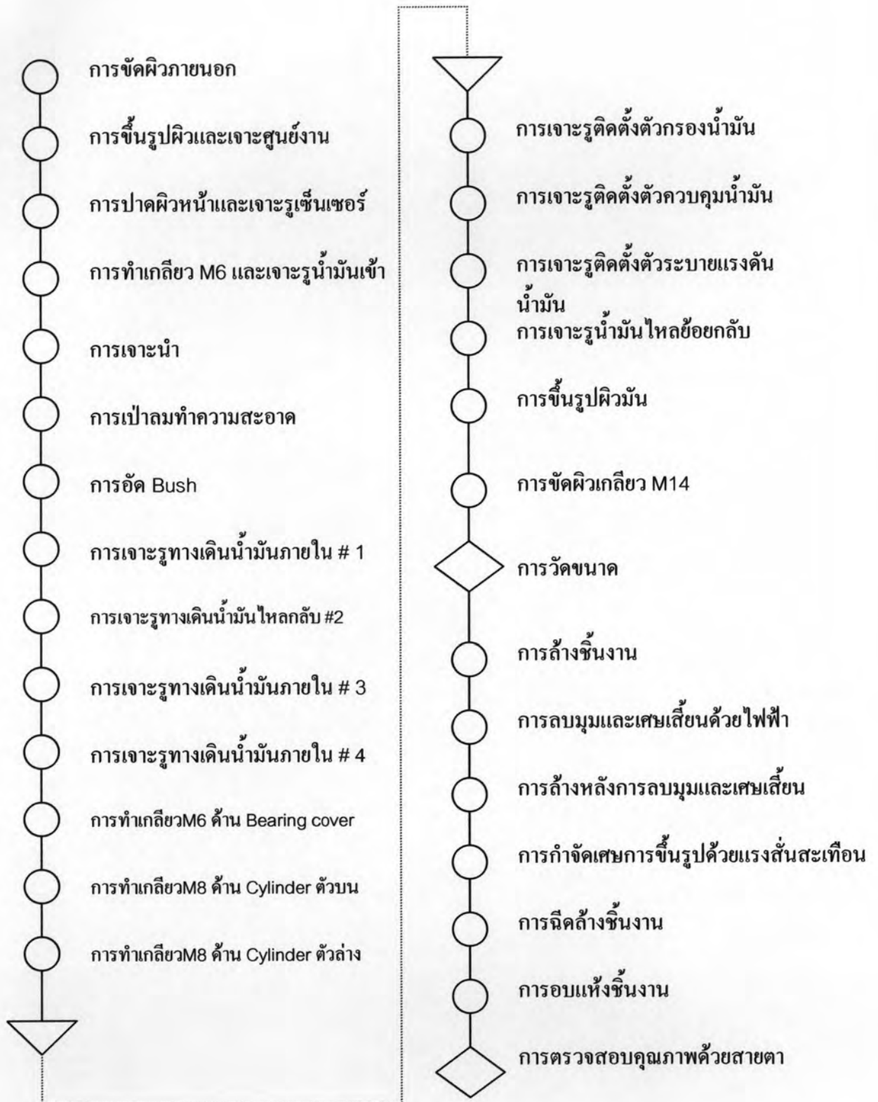
รูปที่ 4.8 กระบวนการทำงานของสายการขึ้นรูปตัวเรือนปั๊ม
