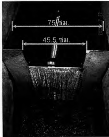
รูปที่ 4-26 แสดงฝายวัดอัตราการไหลของน้ำ ขนาดความกว้าง 45.5 เซนติเมตร
