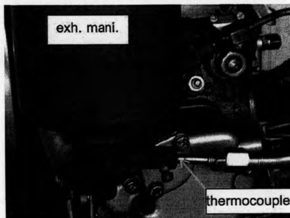
รูปที่ 4-10 แสดงหัววัดของเทอร์โมคัปเปิลที่ท่อไอเสีย
