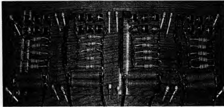
รูปที่ 5.3 วงจรสับเบออร์และความต้านทานแบ่งแรงดันจำนวน 4 ชุด
