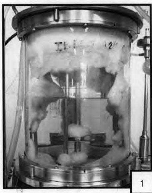
รูปที่ 4.20 แสดงลักษณะพื้นฐานของเซลล์แขวนลอยในถังกวน (1) และลักษณะพื้นฐานของเชื้อรา R. oryzae ที่ถูกตรึงในถังหมักแบบเบดสติก (2)
