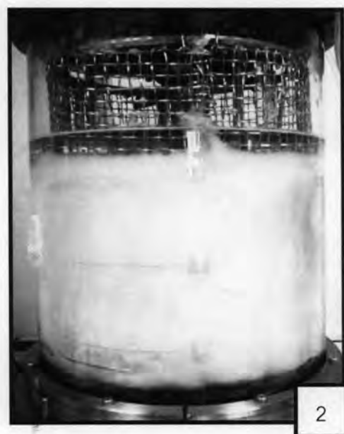
รูปที่ 4.20 แสดงลักษณะพื้นฐานของเซลล์แขวนลอยในถังกวน (1) และลักษณะพื้นฐานของเชื้อรา R. oryzae ที่ถูกตรึงในถังหมักแบบเบดสติก (2)
