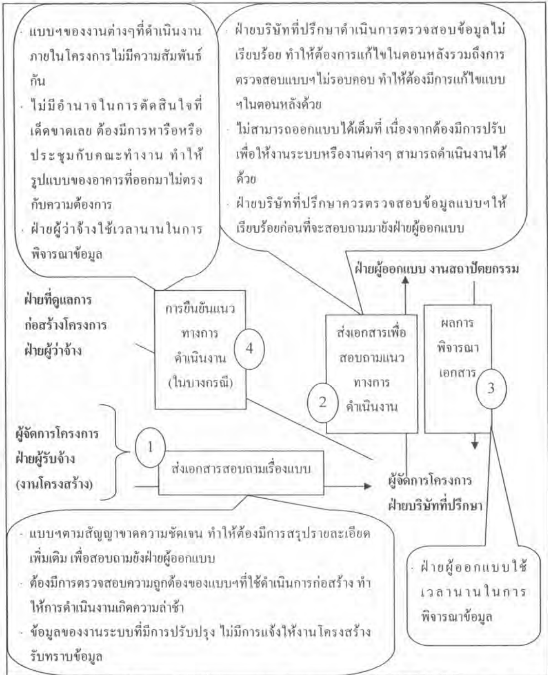
รูปที่ 4.9 ปัญหาที่เกิดขึ้นในแต่ละขั้นตอนการดำเนินงานเอกสารแบบที่ใช้ดำเนินการก่อสร้าง กรณีศึกษาที่ 2
