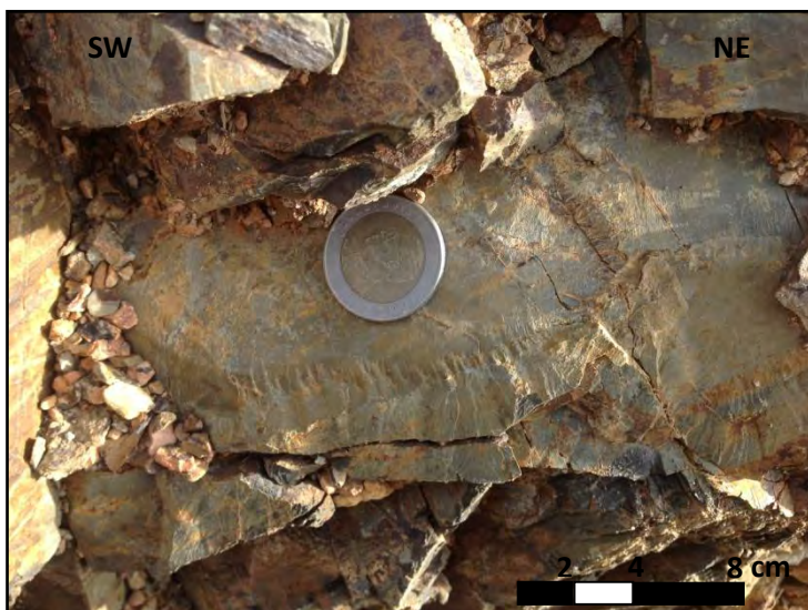
รูป 3.7 En echelon joint แสดงการเฉือนแบบแตกเปราะเคลื่อนที่ตามเข็มนาฬิกา (dextral brittle shear) ในแนวตะวันออกเฉียงเหนือ-ตะวันตกเฉียงใต้ (NE-SW) บริเวณจุดศึกษาที่ 7
