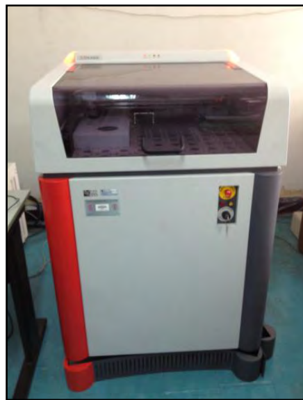
รูป 2.2 เครื่องเอกซเรย์ฟลูออเรสเซนส์ (XRF) ยี่ห้อ Pioneer รุ่น Bruker AXS S4 ยี่ห้อ Pioneer รุ่น Bruker AXS S4 ภาควิชาธรณีวิทยา คณะวิทยาศาสตร์ จุฬาลงกรณ์มหาวิทยาลัย
