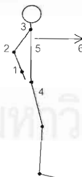
รูปที่ 4.6 ภาพลายเส้นเชื่อมจุดข้อต่อเพื่อคำนวณตามแนวทางชีวกลศาสตร์
