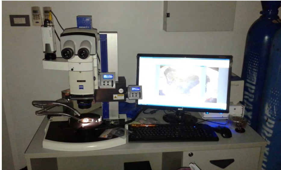
รูปที่ 2.3.1 กล้องจุลทรรศน์อัญมณีที่เชื่อมต่อกับกล้องถ่ายภาพ และคอมพิวเตอร์เพื่อ บันทึกภาพของตัวอย่าง ที่สถาบันวิจัยและพัฒนาอัญมณีและเครื่องประดับ แห่งชาติ (องค์การมหาชน)
