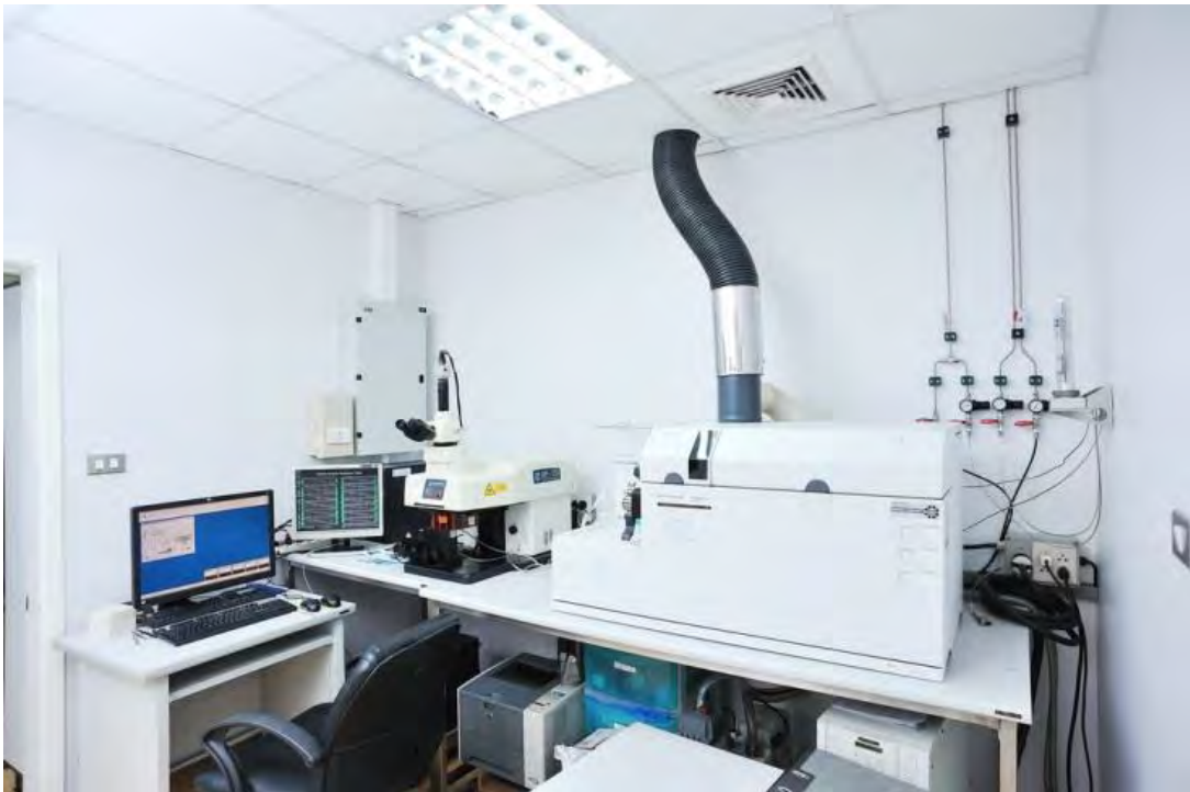
รูปที่ 2.3.2 Laser Ablation-Inductively Coupled Plasma-Mass Spectrometry (LA-ICP-MS) ยี่ห้อ Agilent Technologies รุ่น 7500 Series ที่สถาบันวิจัยและพัฒนา อัญมณีและเครื่องประดับแห่งชาติ (องค์การมหาชน)
