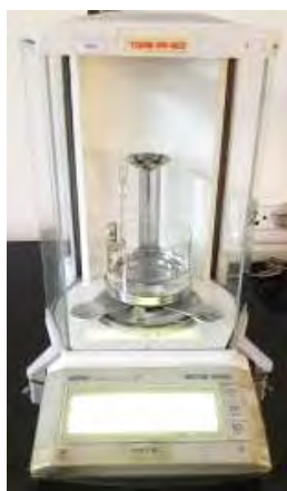
รูป 3.2 Hydrostatic Balance จากสถาบันวิจัยและพัฒนาอัญมณี และเครื่องประดับแห่งชาติ (องค์การ มหาชน)
