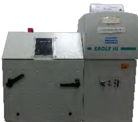
รูป 3.8 เครื่อง EDXRF รุ่น EAGLE III จากสถาบันวิจัยและพัฒนาอัญมณีและ เครื่องประดับแห่งชาติ (องค์การมหาชน)
