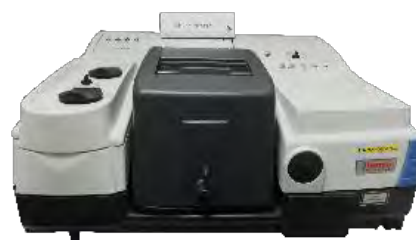
รูป 3.5 เครื่อง FTIR Spectrophotometer รุ่น NICOLET6700 จากสถาบันวิจัยและพัฒนาอัญมณีและเครื่องประดับแห่งชาติ (องค์การมหาชน)
