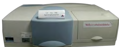
รูป 3.6 เครื่อง UV-VIS-NIR รุ่น Perkin-Elmer จากสถาบันวิจัยและพัฒนาอัญมณีและเครื่องประดับแห่งชาติ (องค์การมหาชน)
