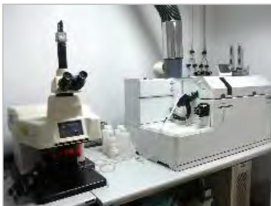
รูป 3.10 เครื่อง Laser Ablation-Inductively Coupled Plasma-Mass Spectrometry (LA-ICP-MS) (LA รุ่น UP-213 และ ICP-MS รุ่น 7500cs) จากสถาบันวิจัยและพัฒนาอัญมณีและเครื่องประดับแห่งชาติ (องค์การมหาชน)
