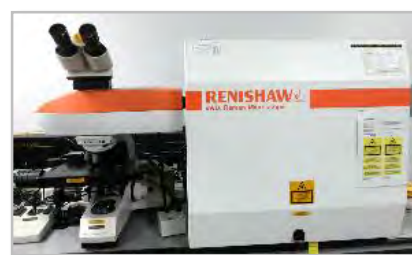
รูป 3.7 เครื่อง Laser Raman Spectroscopy รุ่น Model 1000, Renishaw จากสถาบันวิจัยและพัฒนาอัญมณีและเครื่องประดับแห่งชาติ (องค์การมหาชน)
