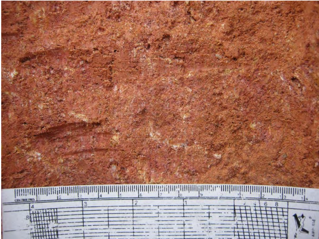
รูปที่ 3 - 7 ลักษณะของ Highly weathered granitic rock ณ จุดศึกษา SDR01 มีความหนาประมาณ 2 เมตร
