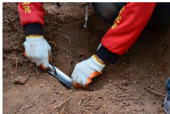
รูปที่ 3.4. แสดงการเก็บแบบไม่รักษาโครงสร้าง
