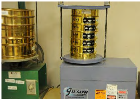
รูปที่ 3.7. แสดงการวิเคราะห์โดยใช้ตะแกรง ( http://www.test-llc.com )
