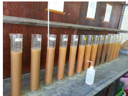
รูปที่ 3.8. แสดงการวิเคราะห์โดยการตกตะกอน
