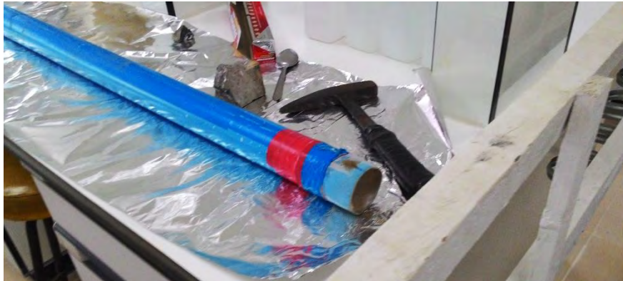
รูปที่ 3.17. แสดงการเปิดฝาท่อโดยใช้ค้อนตอกเพื่อให้ฝาปิดออก
