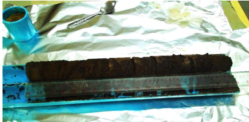
รูปที่ 3.20. แสดงการแบ่งตัวอย่างดินออกเป็นช่วงละ 5 เซนติเมตร
