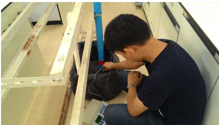
รูปที่ 3.22. แสดงการวัดค่า EC ในอ่างเก็บสารละลายเกลือ
