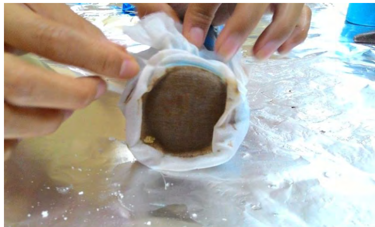
รูปที่ 3.15. แสดงการเก็บตัวอย่างดินโดยเปิดฝาปิดท่อออก
