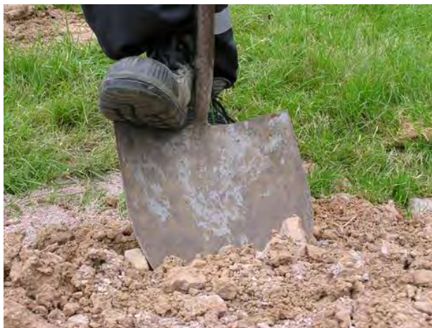
รูปที่ 3.2. แสดงการเก็บแบบไม่รักษาโครงสร้าง ( http://lb2.cdn.spion-media.eu )
