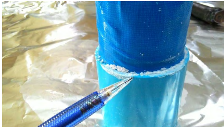
รูปที่ 3.16. แสดงคราบเกล็ดที่ปรากฏให้เห็นที่ฝาปิดท่อ
