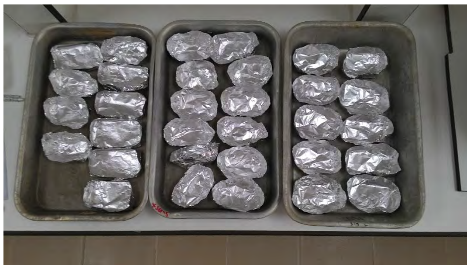
รูปที่ 3.23. แสดงกระดาษฟอยล์ที่ใช้บรรจุตัวอย่างดิน
