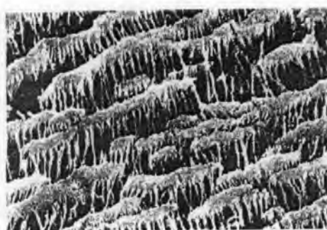
รูปที่ 2.9 รูพรุนของตัวรองรับชนิดแผ่นแบนที่ทำจาก PTFE
