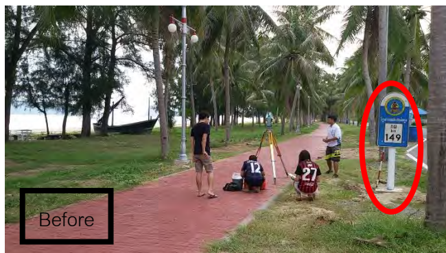
รูปภาพที่ 3.3 แสดงการวัดความสูงของกล้องวัดระดับ ซึ่งในแต่ละพื้นที่จะวางกล้องสูงไม่เท่ากัน ขึ้นอยู่กับความสูงของแต่ละพื้นที่
