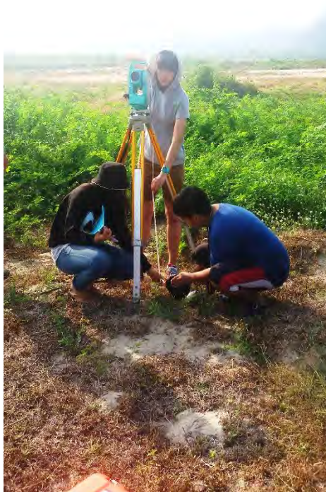
รูปภาพที่ 3.3 แสดงการวัดความสูงของกล้องวัดระดับ ซึ่งในแต่ละพื้นที่จะวางกล้องสูงไม่เท่ากัน ขึ้นอยู่กับความสูงของแต่ละพื้นที่
