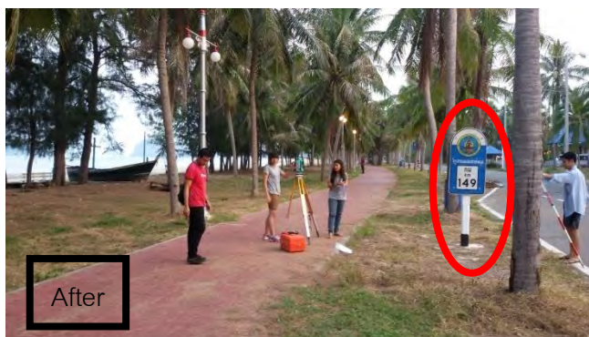
รูปภาพ 3.4 แสดงการวัดระดับชายหาดที่เริ่มวัดจากตำแหน่งอ้างอิง
