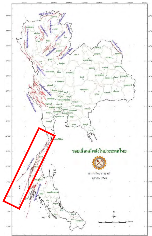
รูปภาพ 2.6 แผนที่รอยเลื่อนมีพลังในประเทศไทย กรอบสีแดงแสดงแนวรอยเลื่อนระนอง (ที่มา กรมทรัพยากรธรณี, 2549)
