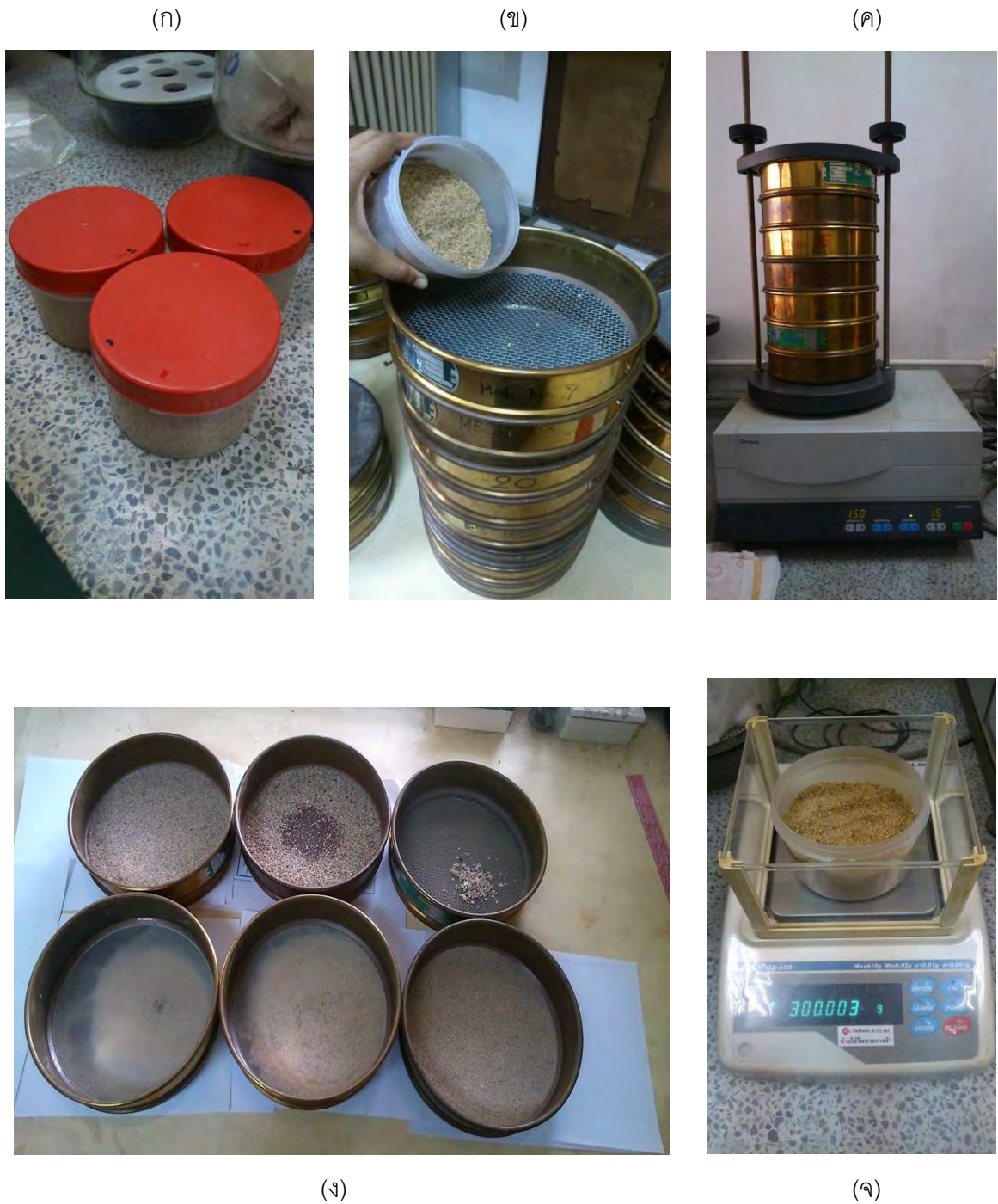
รูปภาพที่ 3.6 ภาพแสดงขั้นตอนการทำ Sieve analysis(ก) ภาพตะกอนที่อบแห้งสนิทปริมาณ 500 กรัม (ข) นำตะกอนใส่ในตะแกรงคัดขนาด ( sieve mesh) (ค) นำตะแกรงคัดขนาดไปวางบนเครื่อง shakerเป็นเวลา15นาที (ง) ตะกอนจะถูกคัดขนาดอยู่ในแต่ละตะแกรง (จ) นำตะกอนแต่ละตะแกรงมาชั่งน้ำหนักและจดบันทึก
