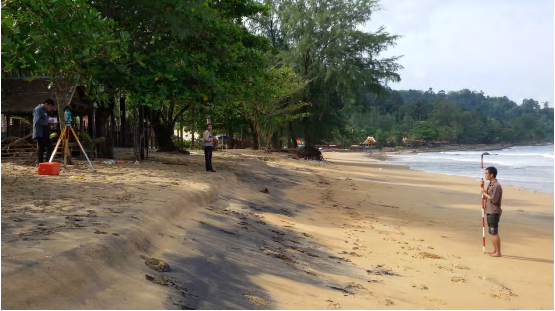
รูปภาพที่ 3.1 แสดงการวัดระดับชายหาด(Beach profiling) ในแนวตั้งฉากกับชายหาดบริเวณหน้าชายหาด (shore face) จุดสำรวจหาดนางทอง
