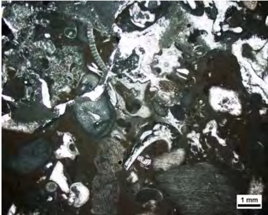
รูปที่ 2.22 ลักษณะภายใต้กล้องจุลทรรศน์ของตัวอย่าง NDB 93-3 แสดงลักษณะของหินเป็น bioclastic packstone พบซากดึกดำบรรพ์ของฟอแรมินิเฟอรา หอยกาบเดี่ยว ไครนอยด์ และสาหร่าย (PPL)
