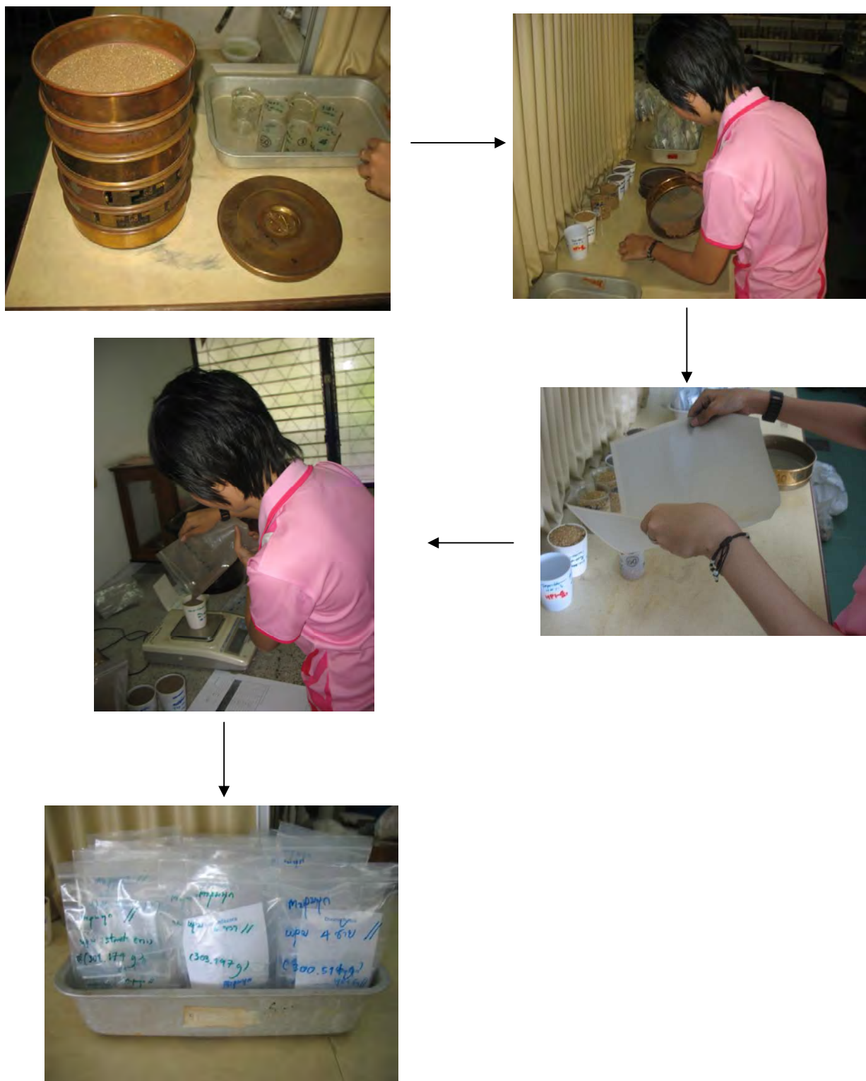
รูปภาพ 3.19 แสดงขั้นตอนการนำตะกอนที่ค้างอยู่ใน sieve แต่ละเบอร์มาชั่งน้ำหนัก
