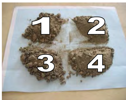
รูปภาพ 3.16 แสดงการเลือกตะกอนที่อยู่ตรงข้ามกันมา 2 ส่วน
