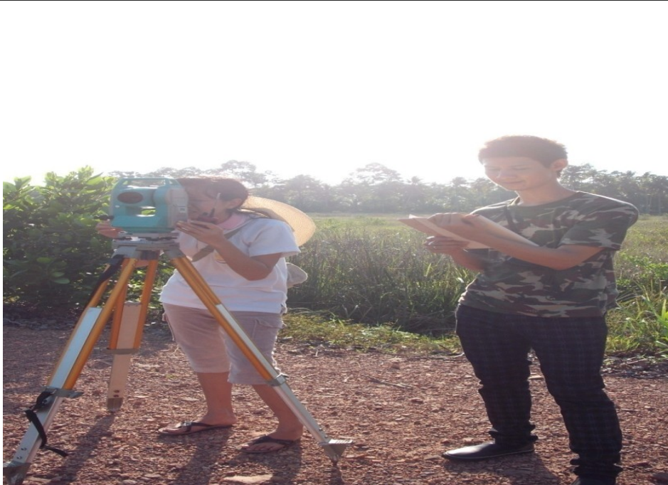
รูป 2.3 แสดงการสำรวจระดับความสูงต่ำของภูมิประเทศโดยใช้กล้องวัดระดับ
